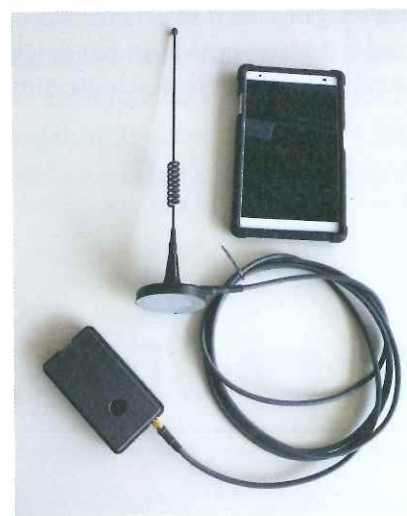
Abb. 5: Ein Tablet oder Handy, eine Antenne und der Ready-Konverter: Mehr ist zur Funkauslesung im „Drive-by-Verfahren“ nicht nötig.
