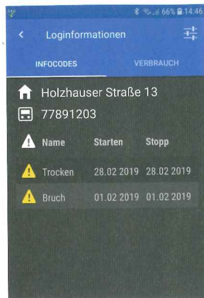
Abb. 3: Auch Infocodes – wie hier z. B. Trockenlauf aufgrund von Manipulation – können aufgezeigt werden.
