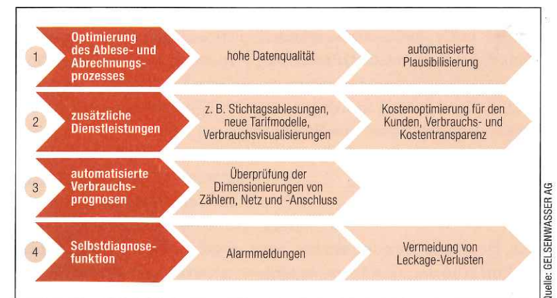
Abb. 3: Verschiedene Möglichkeiten zur Nutzung der Daten aus kommunikativen Zählern
